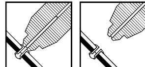
**8** トリガーを放すと、切断されたマンドレルがタンクケースユニットに収納されます。
