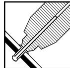
**7** リベッターの先端を母材に軽く押し当て、母材等にすきまがないことを確認した後、トリガーを引きます。
