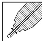
**6** ブラインドリベットのボディ（フランジ）を下穴に挿入します。
