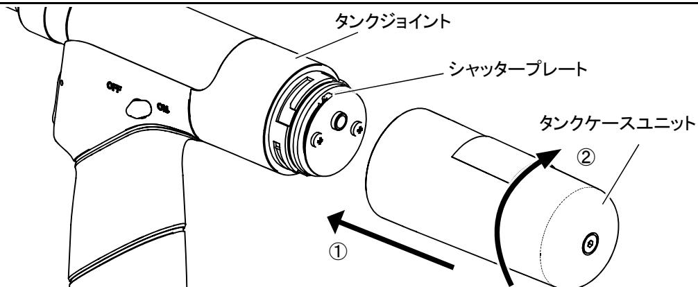
シャッタープレートとタンクケースユニット内の切り欠けを合わせてタンクジョイントに押し当て（①）、タンクケースユニットを時計回りに回して（②）装着します。
