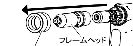
2 フレームヘッドナットを緩めて外し、フレームヘッドを取り外します。
