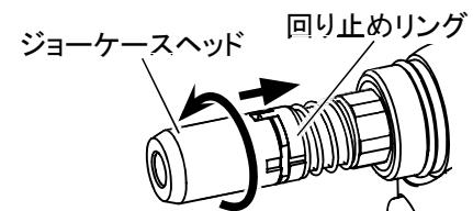
3 回り止めリングを図の方向へ引き、ジョーケースヘッドを緩めて外します。
